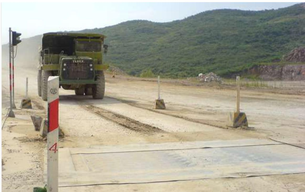
Поосные автомобильные весы SCU/ZCU подходят для эксплуатации в сложных условиях — например, при высокой запыленности.
