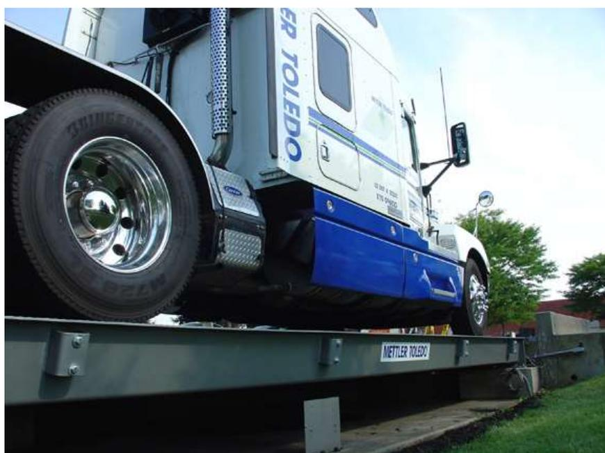
Модель VTS221 легко справляется с нагрузками стандартного потока грузовых автомобилей, распределяя сосредоточенные нагрузки более равномерно, чем конструкции с
