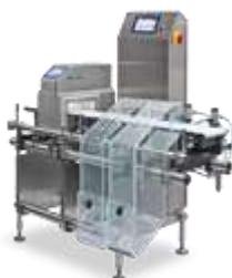
СМ3530 - комбичекер (металлодетектор и чеквейер) с дисплеем 7" и диапазоном взвешивания до 10 кг
