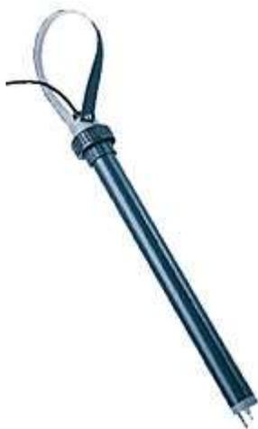
Погружные корпуса серии InDip МЕТТЛЕР ТОЛЕДО предназначены для использования в открытых резервуарах и каналах. Корпуса с установленными в них датчиками / электродами с резьбой Pg 13.5 погружаются в контролируемую среду. Выпускаемые модификации корпусов различаются по допустимой глубине погружения. Детали корпусов, контактирующие со средой, изготавливаются из прочных химически- и абразивостойких полимерных материалов.
