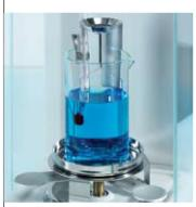
Специальная приставка для определения плотности позволяет легко измерить плотность твердых и пористых тел, а также жидкостей и пастообразных веществ.
