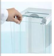
Ветрозащитный кожух аналитических весов MS легко разбирается— все дверки и панели можно быстро снять, вымыть и поставить на место.
