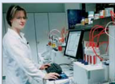
LabX pro titration используется в лаборатории контроля качества для управления различными моделями титраторов Excellence при определении перекисных, аминовых и кислотных чисел химических средств крепления.
