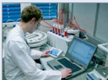
Система титратор Т90 – авторемплер Rondo 60 – программное обеспечение LabX pro titration используется в лаборатории технического контроля для определения числа омыления, кислотных и щелочных чисел смазочных материалов.
