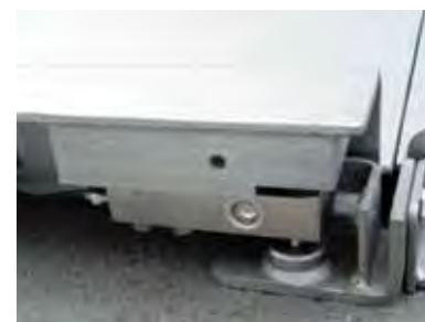
Полностью герметичный весовой датчик весов PCS – нержавеющая сталь, класс промышленной защиты IP68
